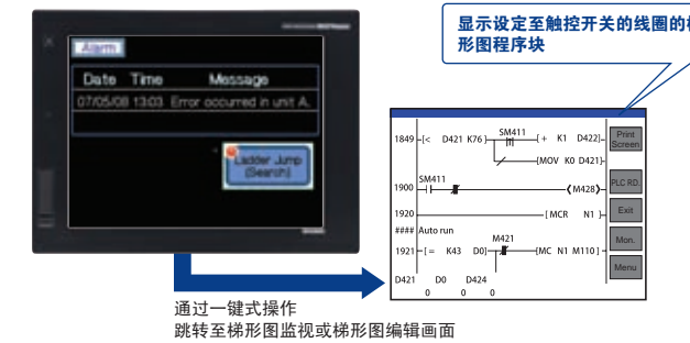
电路符号：从常闭触点改为常开触点。 元件：从M422改为M200。
